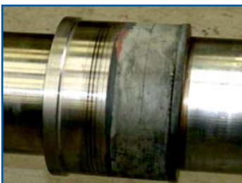
Eingelaufene Läuferwelle im Bereich der Gleitlagerabdichtung
