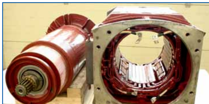
Gleichstrom-Fahrmotor Siemens 185 kW Reihenschluß-Stator und Ankerwicklung von der Brenner GmbH neu gewickelt
