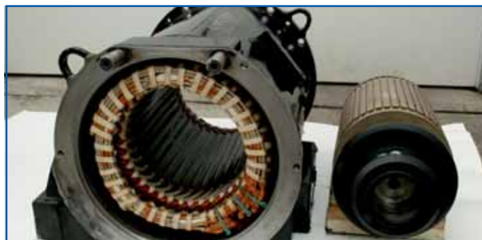
Drehstrom-Bahnmotor 127 kW Drehstrom-Stator und Kurzschlußläufer von der Brenner GmbH neu gewickelt, Kupplung instand gesetzt und gewuchtet
